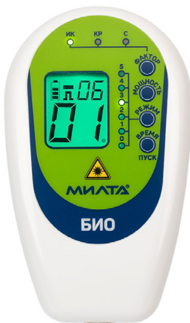
Рис. 1. Лицевая панель лазерного терапевтического аппарата МИЛТА БИО
